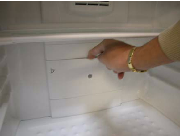
3. Abra la tapa y cambie una vez al año como mínimo el filtro de carbón.
