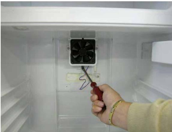
1. Retirer le palpeur du compartiment réfrigérateur de son support et libérer les trois vis de fixation du ventilateur.
