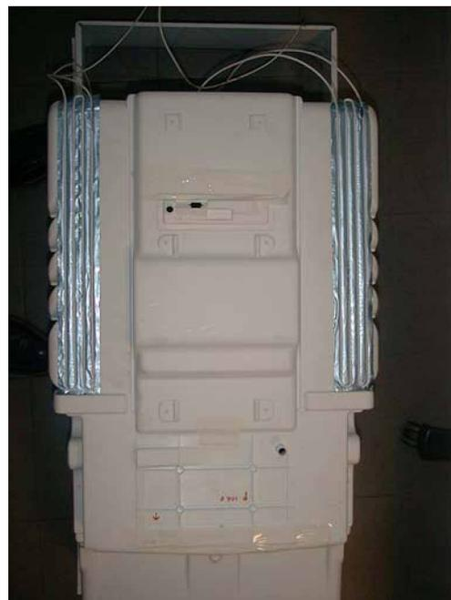
b Vue arrière du compartiment réfrigérateur (avant application de la mousse sur le capot)
