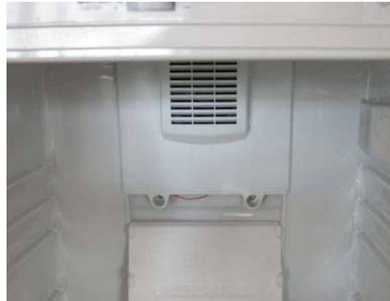
2. Retirer la plaque isolante en polystyrène (n'existe pas pour les appareils avec filtre à air).
