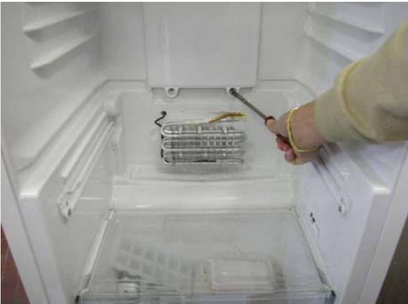
1. Libérer les deux vis de fixation du canal (ou du canal du filtre, si présent); pour l'enlever, tirer le canal vers le bas.
