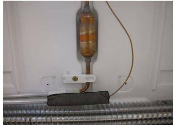
2. Se trouve sous le canal, un dispositif de blocage pour les conduits du filtre destiné à supprimer l'humidité.
