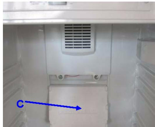
2. Enlevez la plaque isolante en polystyrol C (inexistante dans les appareils avec filtre à air).
