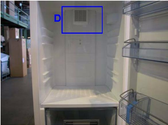
1. Libérez les deux vis de fixation du boîtier ventilateur et dégagez-le vers le bas en tirant.
