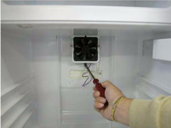
1. Dégager le capteur du compartiment réfrigérateur de son support et libérez les trois vis de fixation du ventilateur.
