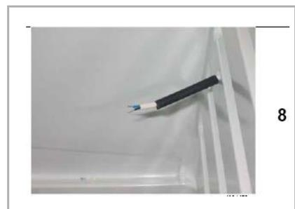
9. Insérer les câbles de la nouvelle sonde température dans les 2 gaines thermorétractables de 15 mm.
