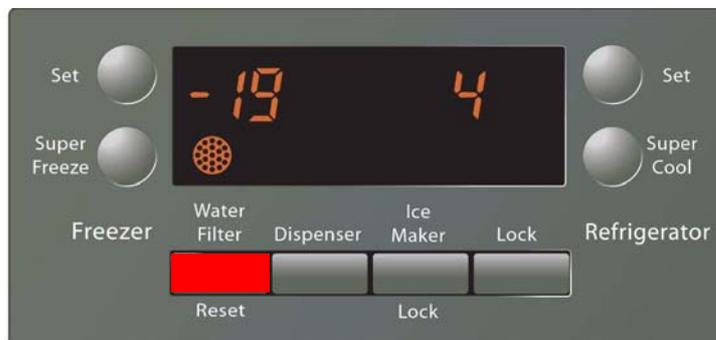
Affichage du remplacement du filtre à eau : une fois le filtre remplacé, maintenir la touche Water Filter Reset appuyée pendant 3 secondes, afin de remettre l'affichage à zéro.
