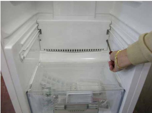
4. Allentare le due viti di fissaggio del rivestimento dell'evaporatore.
