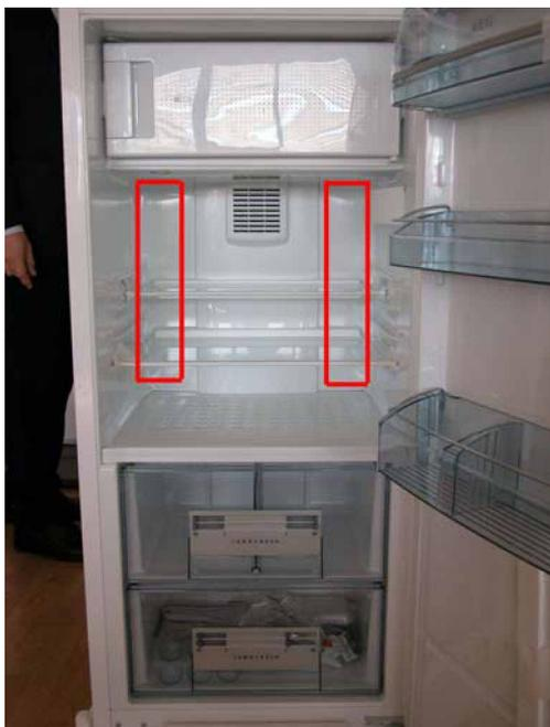
a Vista interna dello scomparto frigo (posizione approssimativa della resistenza di compensazione)
