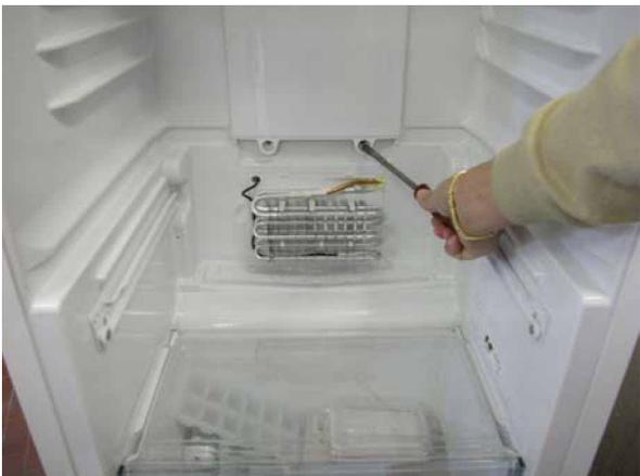
1. Allentare le due viti di fissaggio del canale (o del filtro del canale, se presente); per estrarre il canale, tirarlo verso il basso.
