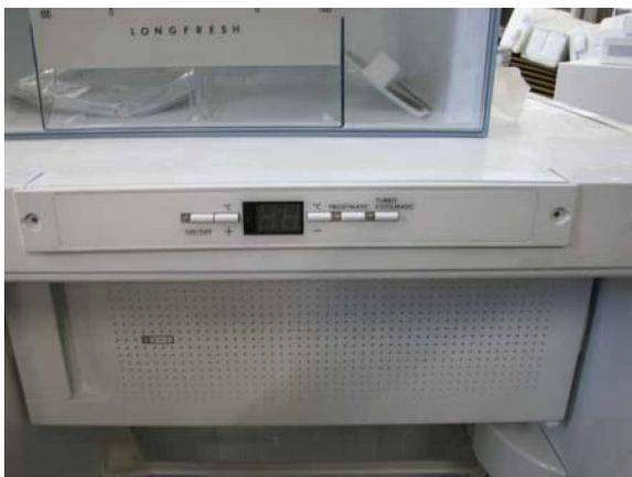
1. Togliere i due rivestimenti delle viti e allentare le 2 viti di fissaggio del supporto del pannello di comando.
