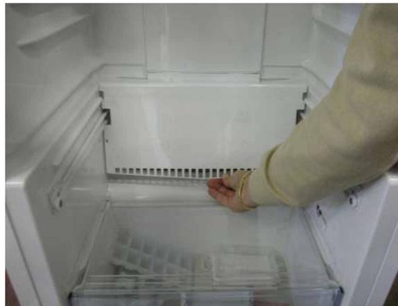
5. Tirare verso di sé il rivestimento dell'evaporatore e rimuoverlo.
