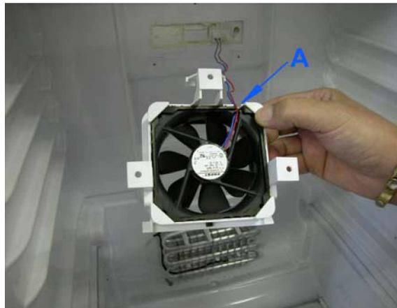
2. I cavi del ventilatore si devono far passare fessura (A) presente nel supporto del ventilatore.
