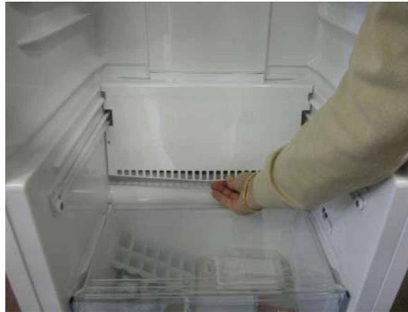
4. Allentare le due viti di fissaggio del rivestimento dell'evaporatore.
