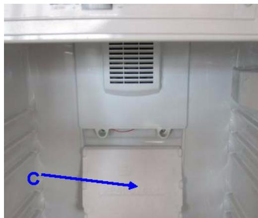
2. Rimuovere il pannello isolante di polistirolo (C). Il pannello non è presente sugli apparecchi con filtro dell'aria.
