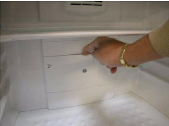
3. Aprire lo sportello e sostituire il filtro a carbone almeno una volta all'anno.
