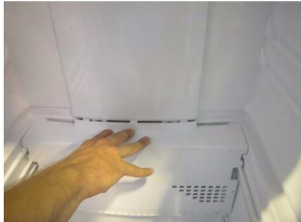
4. Allentare le viti che fissano la copertura dell'evaporatore.
