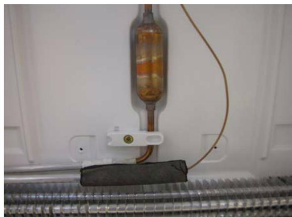
2. Sotto il condotto si trova un dispositivo di arresto per i tubi del filtro deidratatore.
