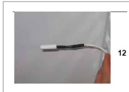
13. Inserire il nuovo sensore nel coperchio alloggiamento sistemando il cavo come indicato in figura.
