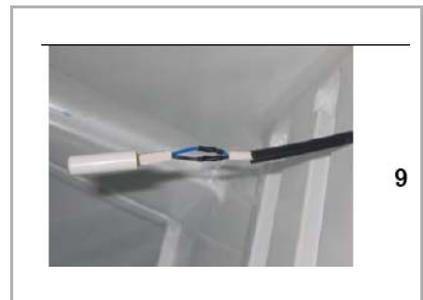
10. Riscaldare la guaina da 50 mm per isolare i cavetti con le giunzioni.
