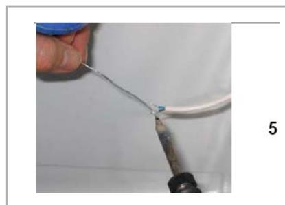
6. Inserire la guaina termorestringente da 50 mm sul cavo del sensore temperatura.
