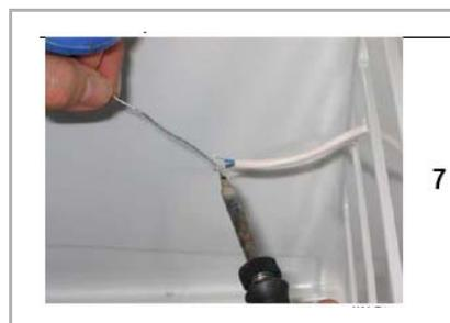
8. Inserire la guaina termorestringente da 50 mm sul cavo del sensore temperatura.
