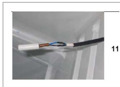
12. Riscaldare la guaina da 50 mm per isolare i cavetti con le giunzioni.
