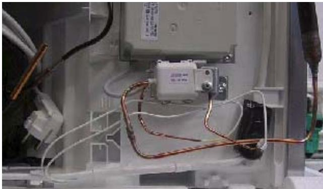
Se un tubo capillare si è rotto sull'entrata del tubo di aspirazione, può essere riparato con due raccordi Lokring NTR (ric. n° 066034).
