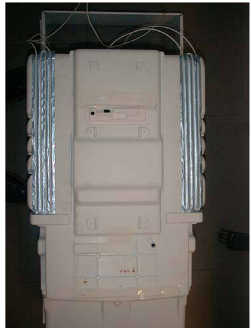
b Achteraanzicht van de koelruimte (vóór het inschuimen van de behuizing)
