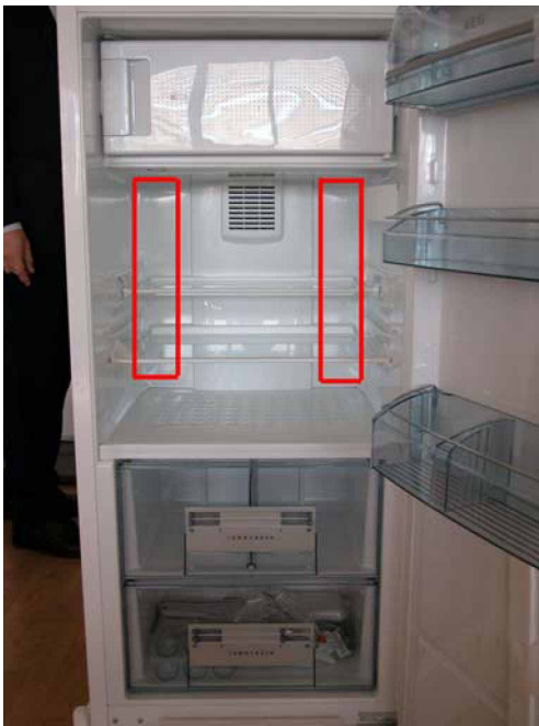
a Binnenaanzicht van de koelruimte (ongeveer de positie van de compensatie-verwarmingselementen)
