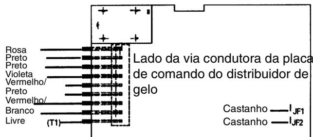
3. Controlar a resistência de aquecimento do distribuidor de gelo relativamente à passagem. Para o efeito, separar o frigorífico da rede eléctrica e medir a resistência de aquecimento entre o condutor neutro e a ligação da resistência de aquecimento. O valor medido deve equivaler aprox. a 4800 ohm.
