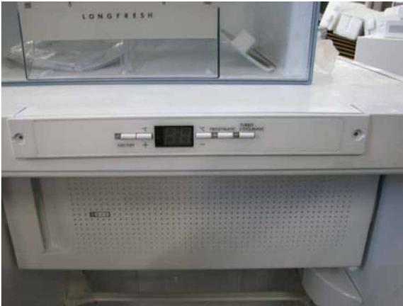
1. Retirar as duas coberturas de parafusos e desapertar os 2 parafusos de fixação da fixação do painel de comando.
