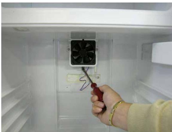
1. Tirar o sensor do compartimento frigorífico do dispositivo de fixação e desapertar os 3 parafusos de fixação do ventilador.
