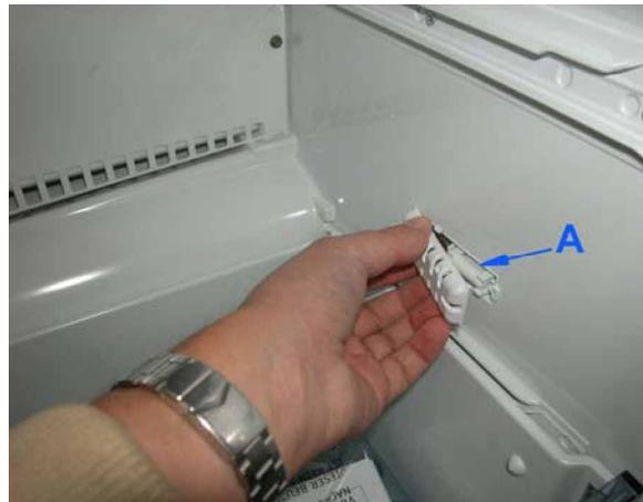
3. Usar uma chave de parafusos com borda chata e retirar a grade protectora do sensor de 0°
