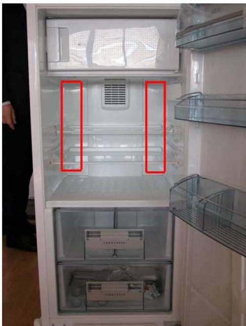
a Vista interior compartimento frigorífico (posição aproximada dos elementos de aquecimento compensadores)
