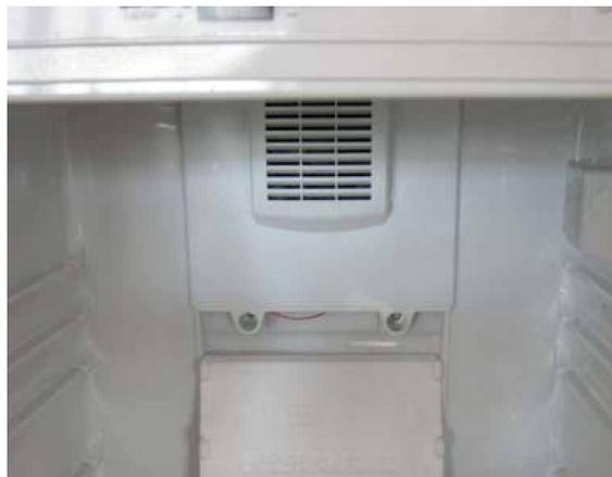
2. Retirar o painel de isolamento de poliestireno (não existente em aparelhos com filtro de ar).
