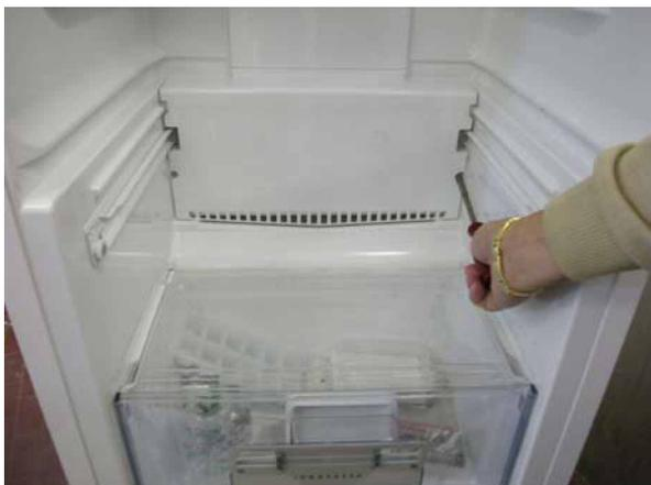
4. Desapertar os dois parafusos de fixação da cobertura do vaporizador.
