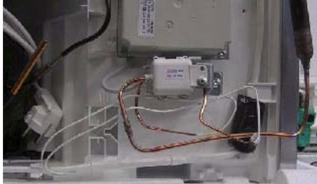
Se um tubo capilar estiver partido directamente na introdução no tubo de sucção, a reparação pode ser efectuada com duas uniões NTR Lokring (n.º pç. de repos. 066034).
