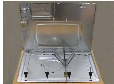
Para acceder al motor del plato giratorio hay que retirar la placa (1) de la placa del fondo, separar el motor del suministro de corriente (2) y retirar los dos tornillos (3).
