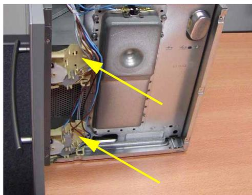
Les deux supports sont fixés par 2 vis derrière la porte.
