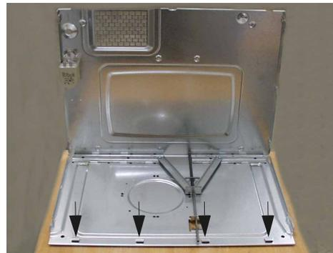
Per raggiungere al motore del piatto rotante (1), eliminare la piastra dalla piastra del fondo, separare il motore dalla rete elettrica (2) e togliere le due viti (3).
