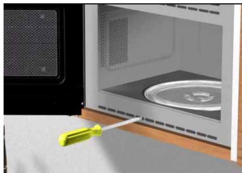
Fissare l'apparecchio con una brugola 2mm come mostrato nell'illustrazione.
