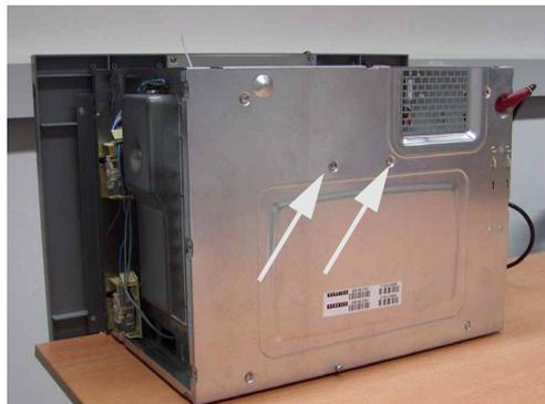
Magnetrão com suporte, parafusos e a protecção contra sobre-aquecimento (NTC).
