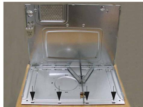
Para chegar ao motor do prato giratório, retirar a placa (1) da placa do fundo, separar o motor da alimentação de corrente (2) e retirar os dois parafusos (3).
