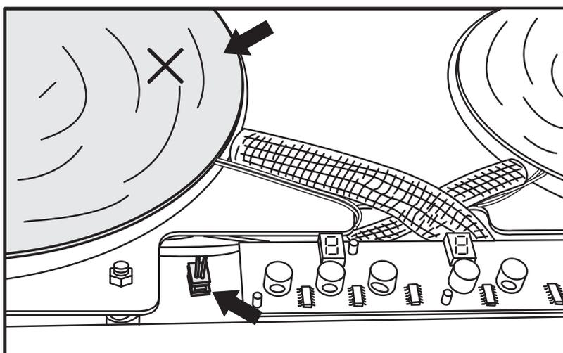
Stecker abziehen und Fühlerleitung unter dem Blech herausziehen.
