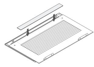
Schutzfolie vom Blechstreifen entfernen und zwischen die beiden Befestigungslöcher vom Türgriff auf die Innenseite der Frontscheibe kleben.
