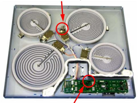
Signalleuchte mit Isolierband abkleben.
