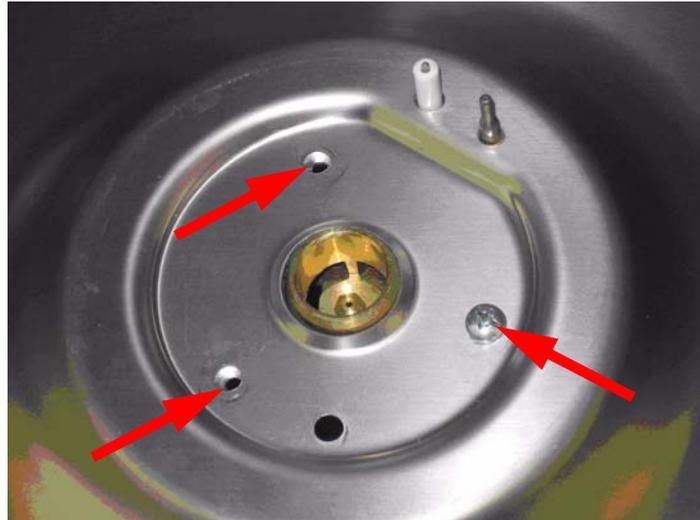
Die 3 Befestigungsschrauben der Brenner nach dem Festschrauben um eine viertel bis halbe Umdrehung lösen.
