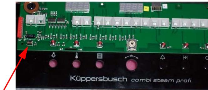
Der Schaltnocken dieser Taste muß abgebrochen werden, weil in der Bedienblende keine Öffnung dafür vorgesehen ist und der Schaltnocken je nach Druck auf die anderen Tasten sofort einen Fehler auslöst.
