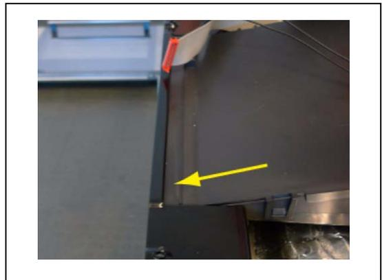
Des weiteren müssen die Stützen des Lüftungskanals wieder sauber eingefahren werden.
