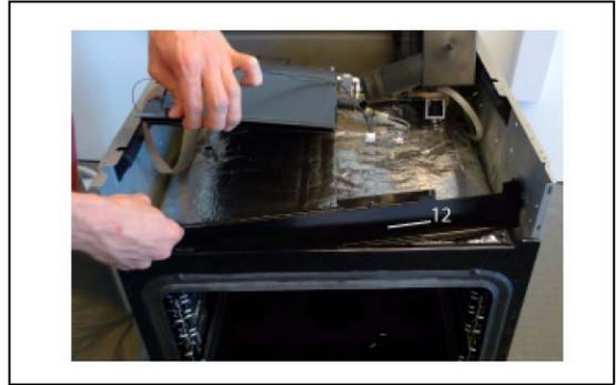
7. Im ausgebautem Zustand kann der "alte" Querträger mit dem "neuen" verglichen werden.
