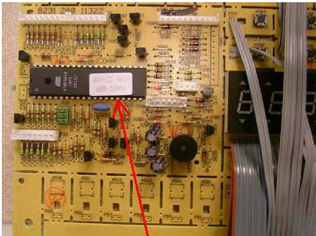
In diesem Beispiel ist das Produktionsdatum der Platine W05-23
