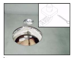
5. Durch die Lampenfassung setzen Sie nun den Splint in die Öffnung.
