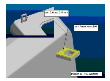
Durch diese Verbesserungen kann die Schließplatte mechanisch gut funktionieren und ist besser stabilisiert.
