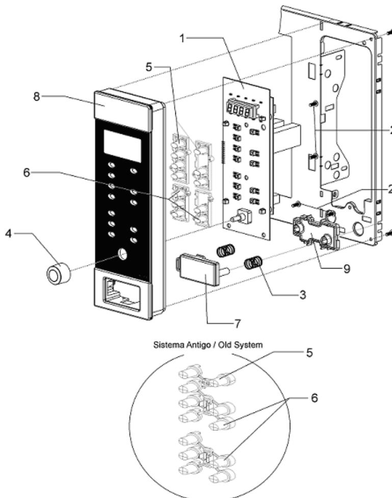
**Hinweis:** Bei der Montage des Bedienfeldes EMWG 60.0M BIS muss zuerst die Encoder-Taste eingesetzt werden und erst danach sollen die Tastensätze eingesetzt werden.
