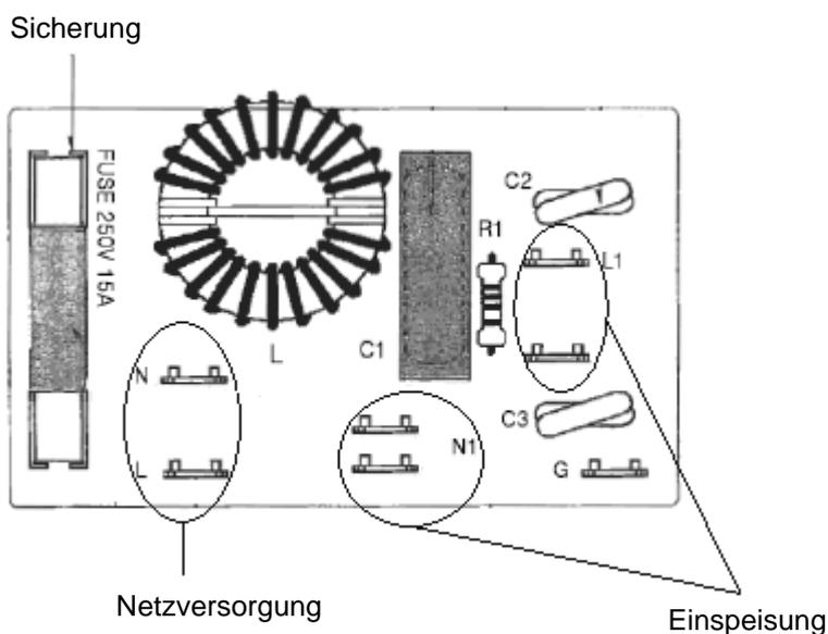
ET-Nr. 528906 - RFI-Filter III (Funkfrequenzfilter III)
