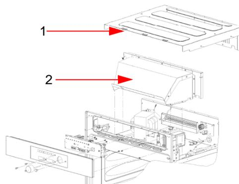
3. Nach Abschluss dieser zwei Schritte ist der Zugang zur Lagerung der Lampenhalterung möglich. Seitliche Crimps der Lampenhalterung mit Hilfe eines Schraubendrehers nach unten drücken wie in der Abbildung dargestellt.
