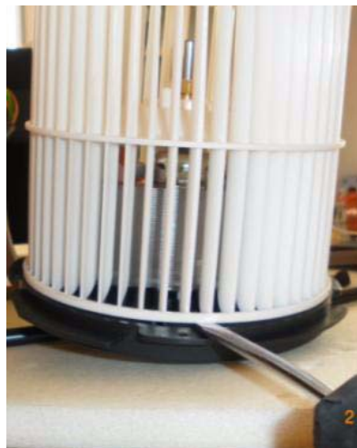
Abb. 8: Vor dem Wiedereinbau sicherstellen, dass es keine Berührung zwischen Lüfterrad und Motorgrundplatte gibt.
