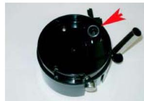
3. Reinigen Sie auch die Öffnung an der anderen Kupplung.
