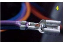
7. Etwaige scharfe Kanten von der neuen Anschlussklemme abschneiden, um ein korrektes und vollständiges Einsetzen in den Verbinder zu gewährleisten.
