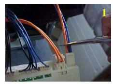
4. Nur soviel von der Kabelummantelung entfernen, wie es für ein korrektes Einsetzen in den Verbinder erforderlich ist.
