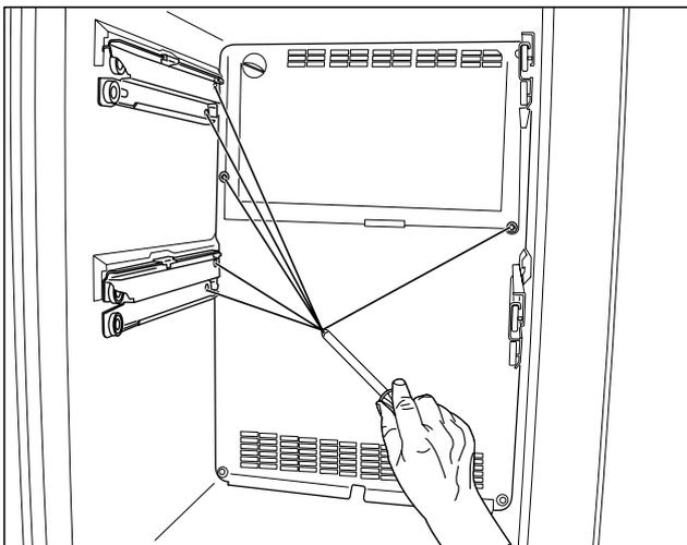
Schrauben lösen und die beiden Laufschielen auf einer Seite ausbauen.
