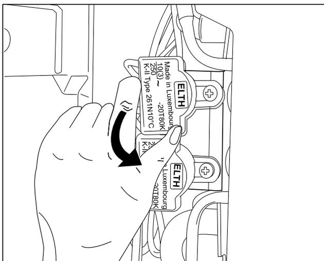
Die Befestigungslasche, auf der der Abtasterthermostatschalter sitzt, leicht nach vorne biegen, damit die Thermostatschalter nicht im direkten Luftstrom vom Heizwiderstand des Verdampfers liegen.
