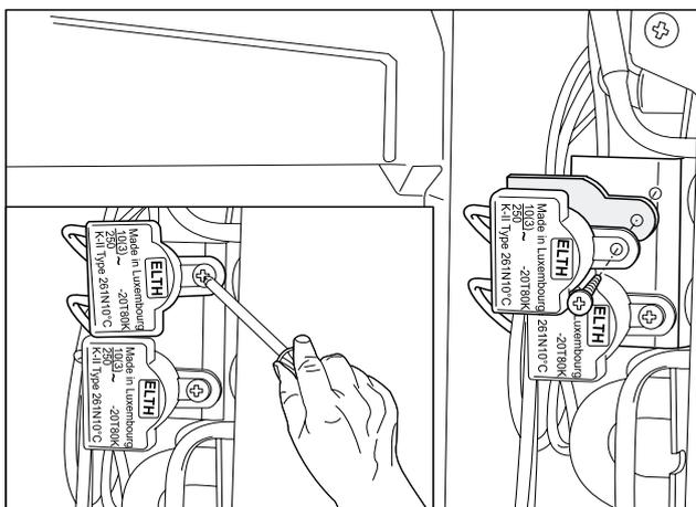
Abtasterthermostatschalter (oberes Thermostat) lösen.
