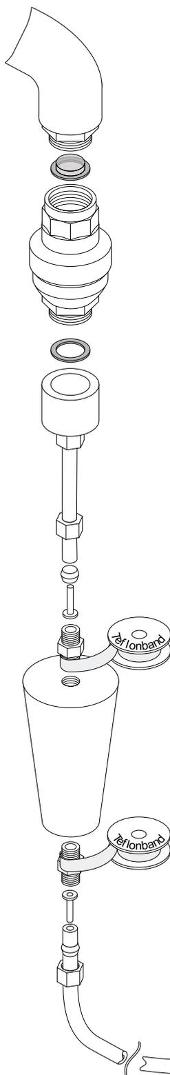
Geräteanschlußventil mit integriertem Rückflußverhinderer
