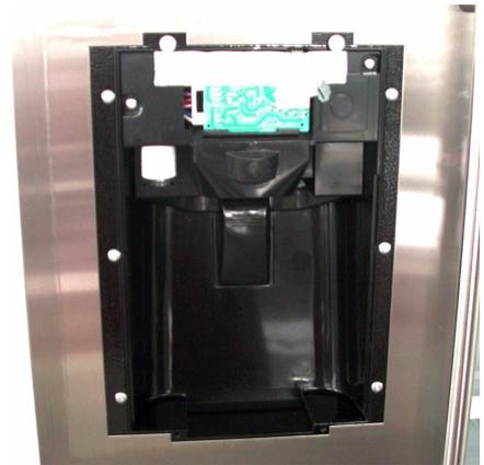
Metallverkleidung der Tür an den Klebestellen mit einem Föhn von außen erwärmen (Sitz der Klebestellen siehe Neue Tür). Mit Hilfe eines Flachsraubenziehers Metallverkleidung abheben und eventuelle alte Klebereste entfernen. Neue Metallverkleidung anbringen und Klebestellen mit der Hand fest andrücken. Zusammenbau des Gerätes in umgekehrter Reihenfolge.
