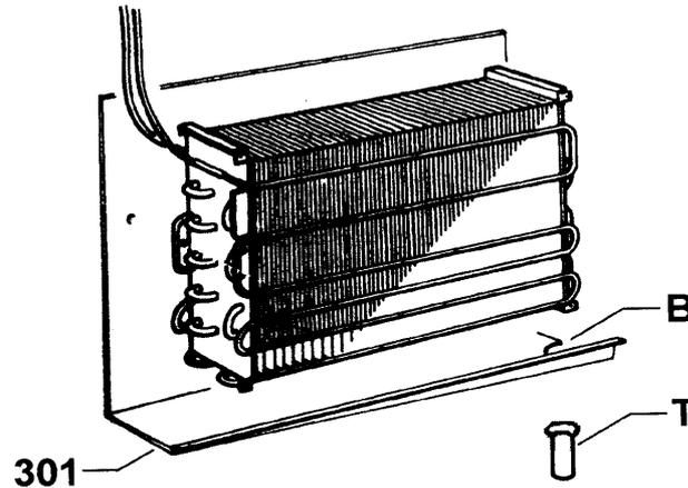
Durch diese Änderung wird die Eisbildung vermieden, die durch den Kontakt des Wassers mit den kalten Teilen des Gefrierfaches verursacht wird und wodurch sich dann das Leckwasser im Gefrierfach bildet.
