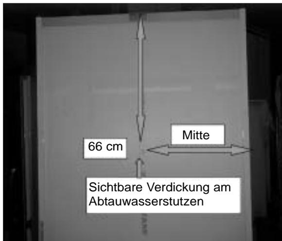
In der Rückwand ein 9x7 cm großes Fenster ausschneiden und umklappen. Den Schaum um den Abtauwasserschlauch entfernen.
