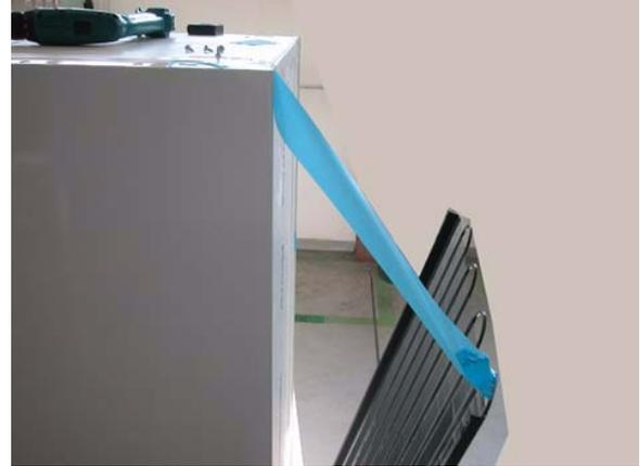
4. Die Befestigungsschrauben des Kondensators entfernen und diesen mit Klebeband am Gehäuse befestigen.
