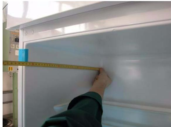
1. Die charakteristische Einbuchtung im Kühlraum suchen. Darunter fängt der Röhrenverdampfer an.
