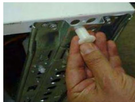
3. Schlagen Sie anschließend die Gewindehülse mit einem Hammer ein.
