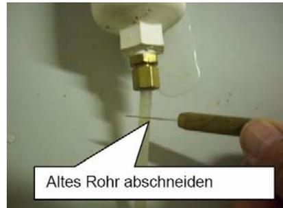
Das Beispiel zeigt den Anschluß eines Schlauches mit 6,3 mm Durchmesser.
