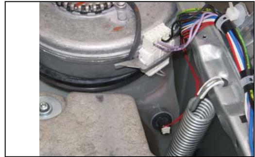
2. Lösen Sie die Steckverbindung und isolieren Sie diese.
