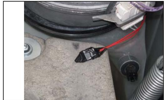
3. Befestigen Sie die isolierte Steckverbindung (Kabelbinder).
