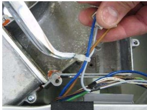
**ACHTUNG!** Vor der Montage des Heizelements unbedingt den Rand des Heizelements mit einem geeigneten Kleber abdichten. Das Kabel wieder in den Steckplatz einsetzen.
