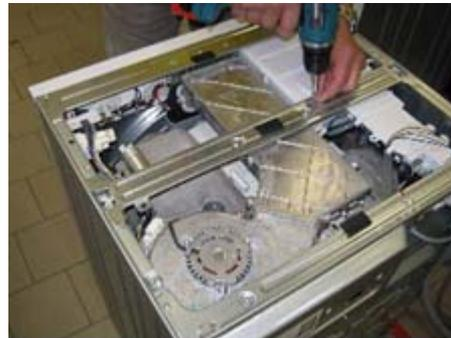
3. Schrauben der Trocknerabdeckung lösen.
