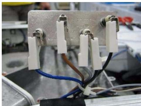
5. Das Heizelement durch das neue Heizelement ersetzen.
