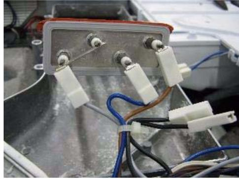
Die schwarze „Drahtbrücke“ entfernen. Hierzu zunächst die Faston-Stecker abschneiden.
