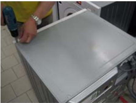
2. Schrauben der oberen Querstange lösen.
