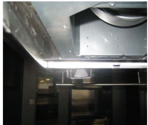
Fig. 2 Remove the halogen lamp
