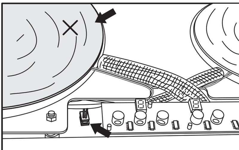
Desenchufar la clavija y extraer la línea del sensor por debajo de la chapa.
