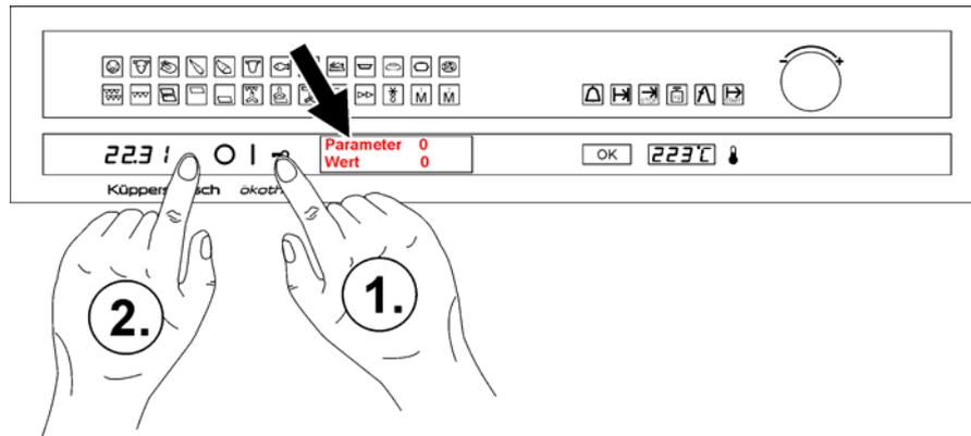
Pulse primero la tecla «Seguro para niños», y después y un poco más de tiempo la tecla tapada «Ajustar reloj» que se encuentra entre el reloj y la tecla de desconexión «O». En la indicación aparece: PARAMETRO: 0 y VALOR: 0.00.
