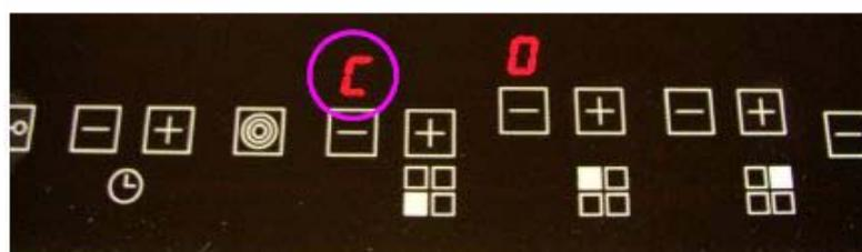
En la indicación de la zona de cocción delantera izquierda aparece C - 0 - C - 0 -
