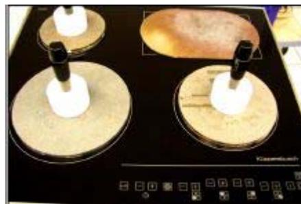
Si la calibración se ha llevado a cabo con éxito en todas las zonas de cocción, el control concluye por sí mismo el proceso de calibración. Suena un tono de señal y el control pasa a estar en el funcionamiento normal, es decir que el Touch Control está en OFF en espera de ser conectado con el interruptor principal.
