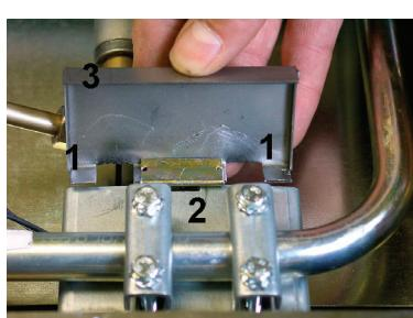
3. En GKS 300 Gas y GKS 300 WOK, el juego de servicio se coloca de manera que las superficies (1) queden sobre la chapa de soporte (2). La superficie superior (3) de la clapa de apoyo se apoya después de haber atornillado el fondo.
