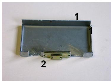
2. El juego de servicio se compone de una clapa de apoyo (1) con resorte (2). Para GKS 300 WOK (fabricación antes de septiembre de 2003) hay que emplear el juego de servicio con una altura de montaje de 54,5 mm, en tanto que para el resto de los tipos hay que emplear el juego de servicio con la altura de montaje de 39,5 mm.
