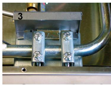
4. En GWS 457.0 WOK se emplean dos juegos de servicio, los cuales se emplazan de manera que las superficies (como se muestra en la figura 3) quedan sobre las dos chapas de soporte. Las superficies superiores (3) de las chapas de apoyo se apoyan en su cara interior después de haber atornillado el fondo.
