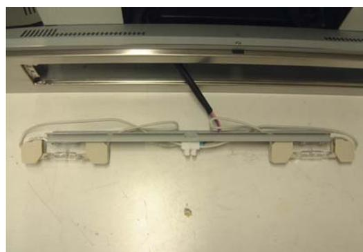
Para el montaje del nuevo portalámparas hay que retirar primero el cristal de la lámpara. Después hay que aflojar los tornillos del portalámparas y separar seguidamente la conexión eléctrica.
