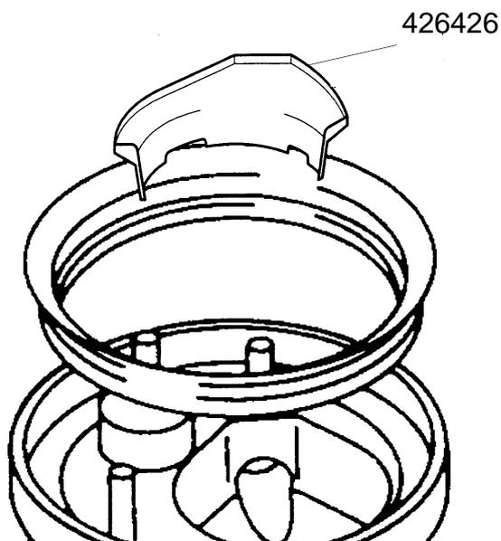
Mit Montage der Ansaugkappe vor der Ansaugöffnung der Umwälzpumpe werden folgende Punkte verbessert:
