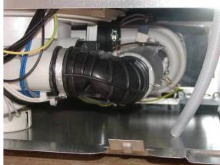
Para ello puede usted oprimir ligeramente con un destornillador sobre el tubo y observar cómo se comporta éste, o desconecte y conecte de nuevo el lavavajillas durante el ciclo de lavado. Si el tubo resbala hacia afuera, ello significa que hay que recambiar el codo. No resulta suficiente con volver a insertar de nuevo el tubo, porque éste está torcido y volvería a salirse una y otra vez.
